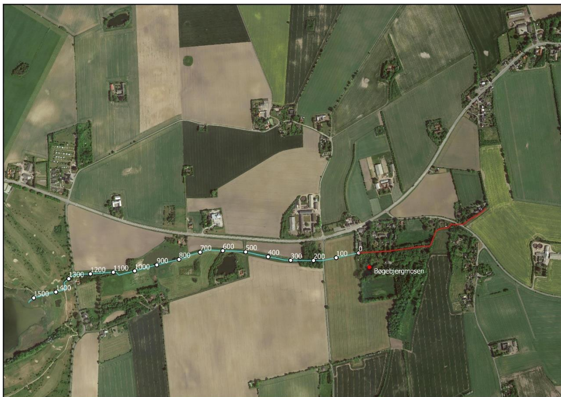
Figur 7-1. Stationering på den offentlige del af Landsledgrøften, fra Bøgebjergmose og nedstrøms. Den private strækning er markeret med rødt, og regulativstrækningen er markeret med turkis.
