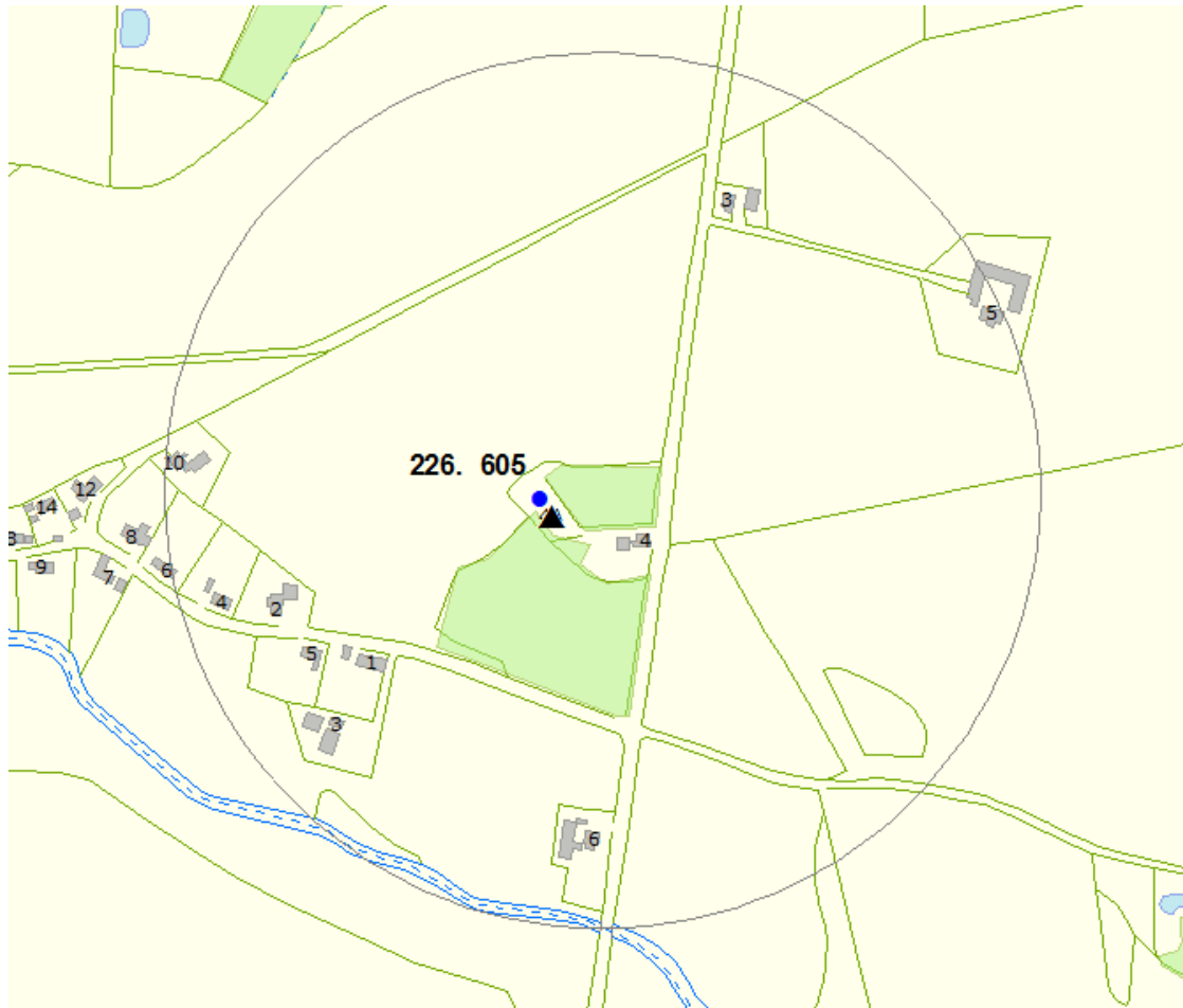
Fig. 2 Faksinge Gishale vandværk ▲ og aktive bornings placering ●, samt 300 meters beskyttelseszoner omkring boringer.
